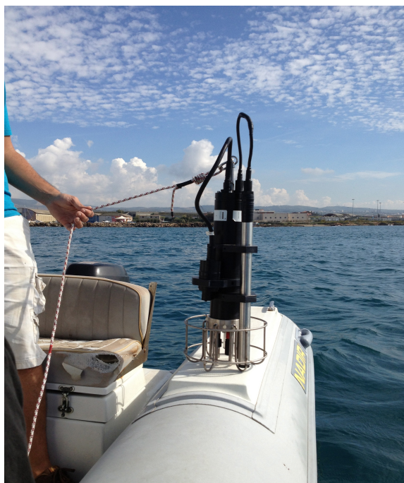
Fig. 4 Profili verticali con Sonda multiparametrica
